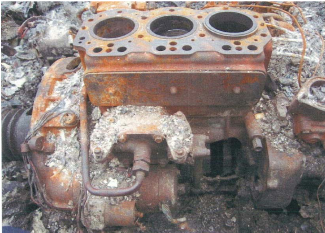
写真4 1番シリンダのシリンダブロック破損状況
