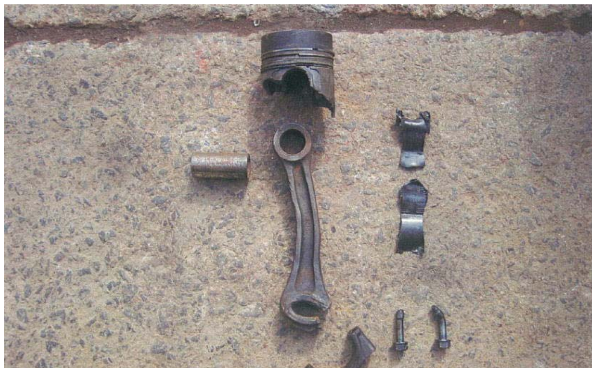
写真5 1番ピストン及び接続棒等の損傷状況
