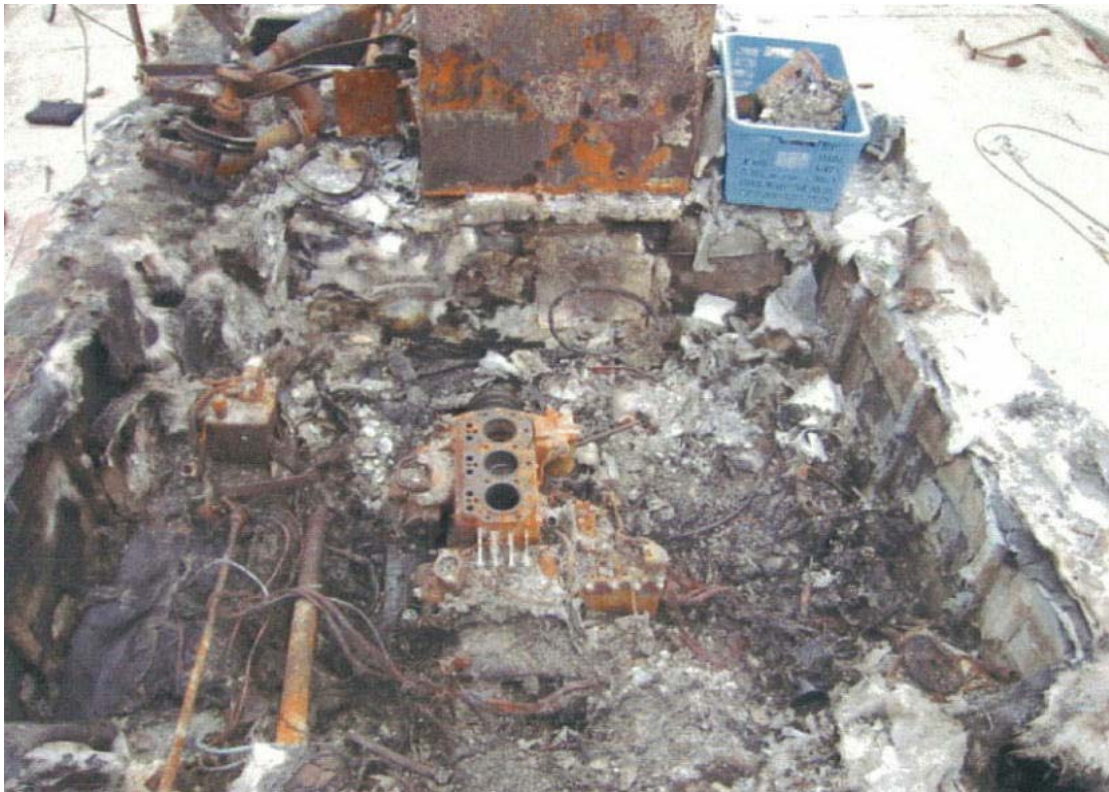
写真4 1番シリンダのシリンダブロック破損状況
