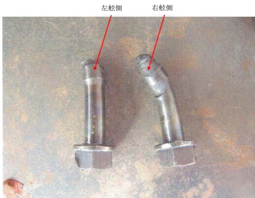
写真6 クランクピンボルトの損傷状況
