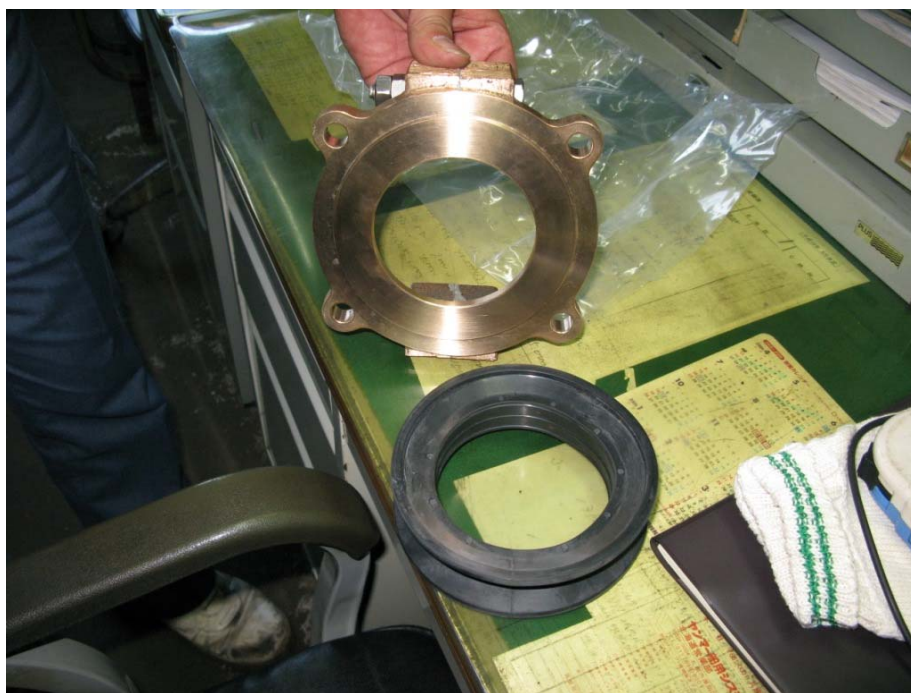
写真2 船尾管シール装置のシール当たり面
