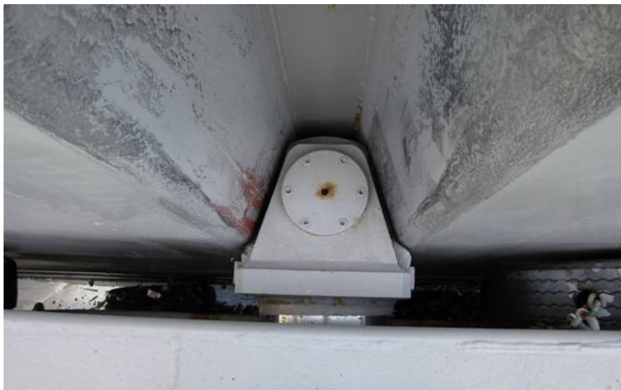
写真5 A船油圧アームのピンとB船凹部との合体状況
