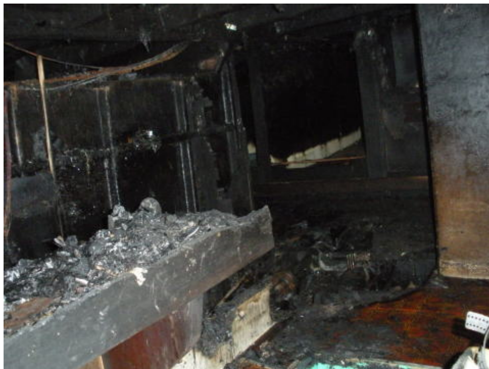
写真2 船員室の焼損ベッド
