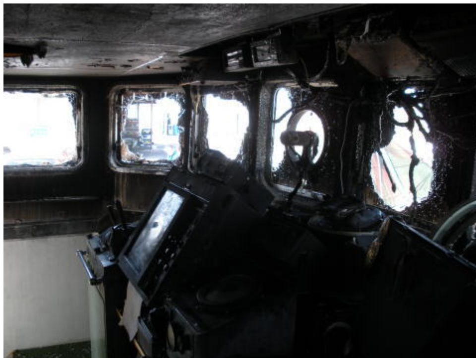
写真4 操舵室の焼損状況
