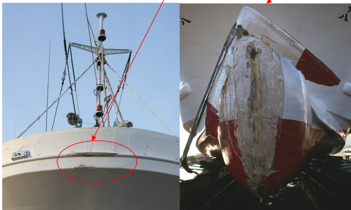
写真3 船首部損傷状況
