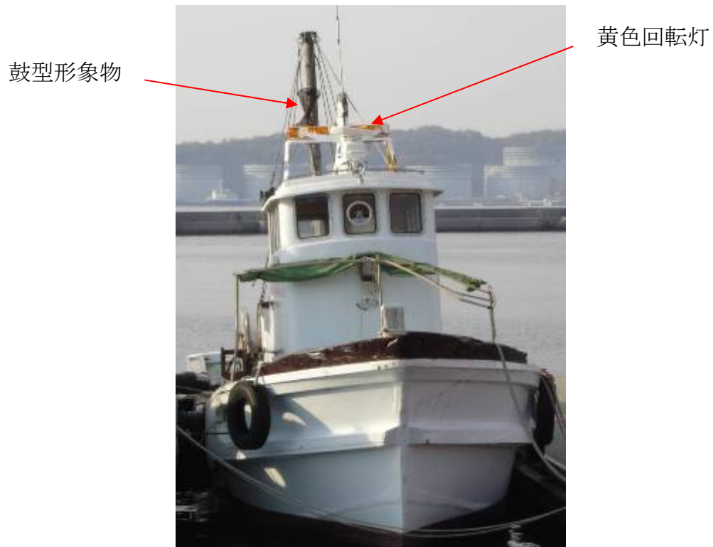
写真4 B船の灯火、形象物の状況
