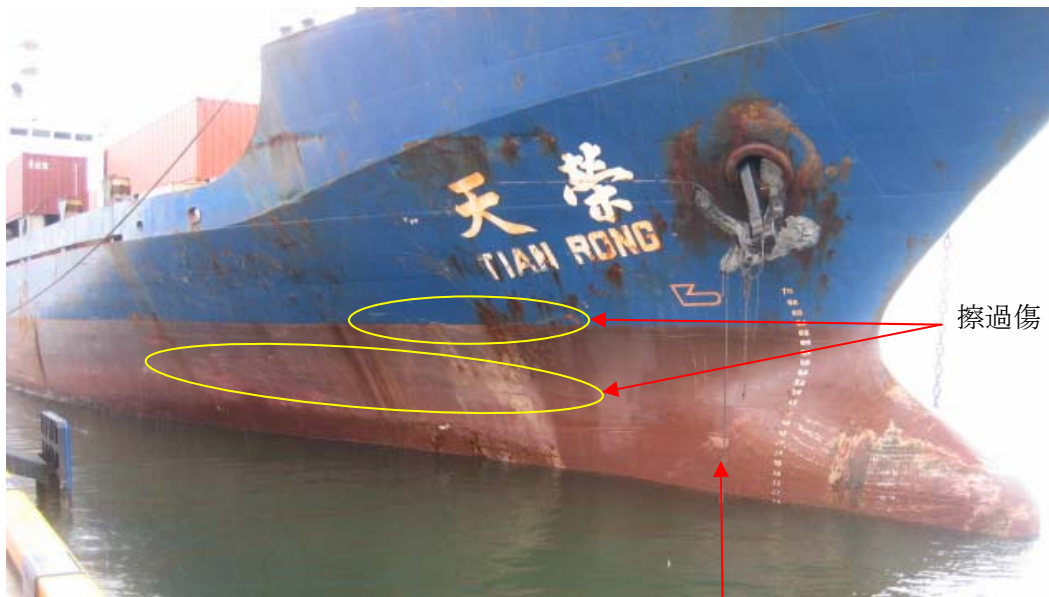
写真1 A船右舷船首の損傷状況
