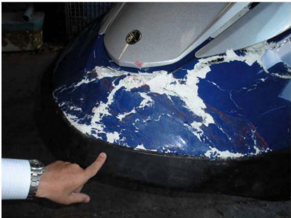
写真2 船首上部の損傷状況
