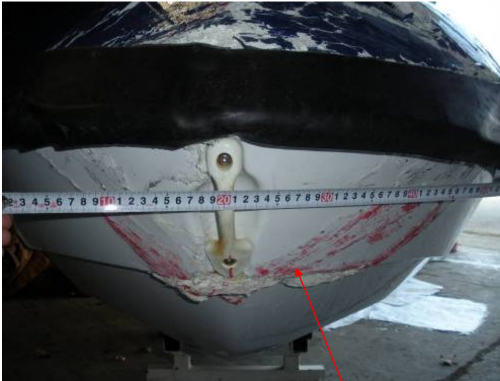
写真3 船首下部の損傷状況
