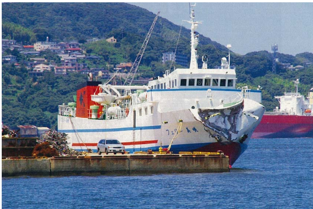
写真1 本船衝突後の全景
