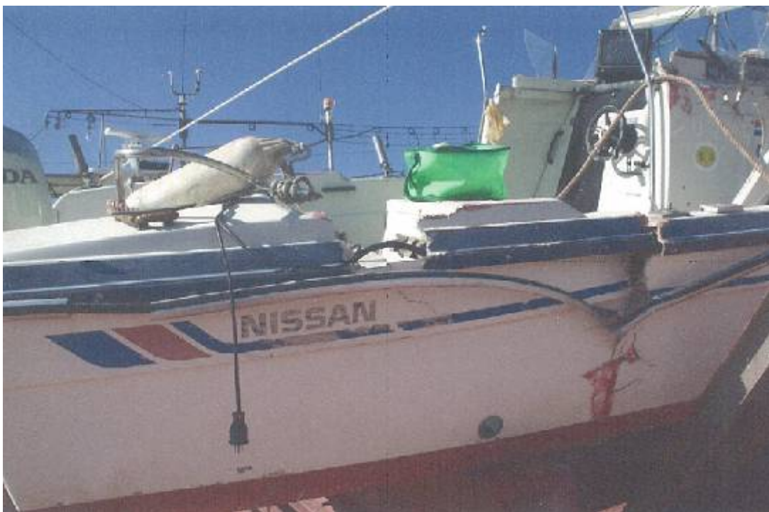
写真2 B船の右舷船尾ブルワーク外板の損傷状況
