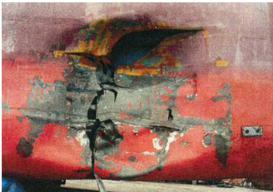
写真3 C船左側外板損傷
