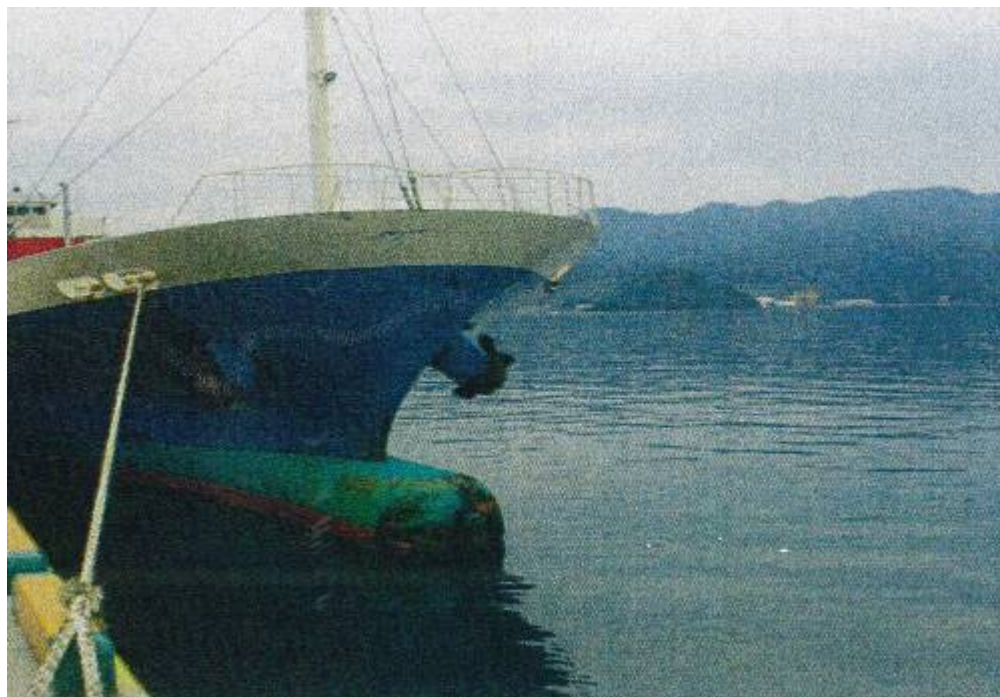
写真1 A船船首部損傷
