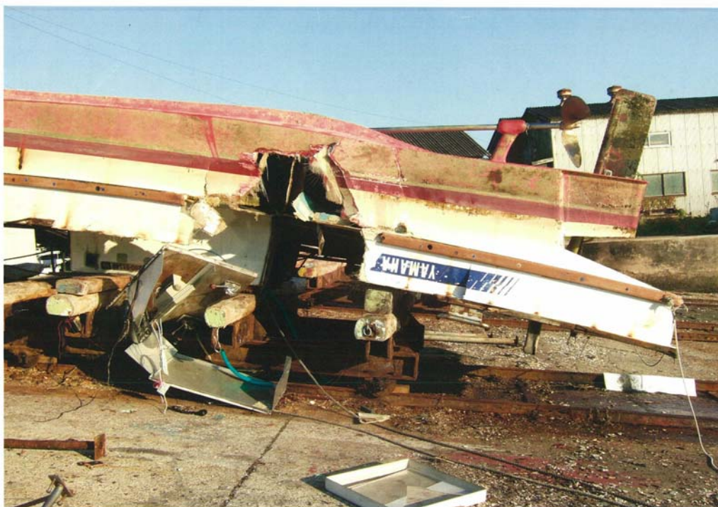
写真4 B船右舷船尾損傷状況
