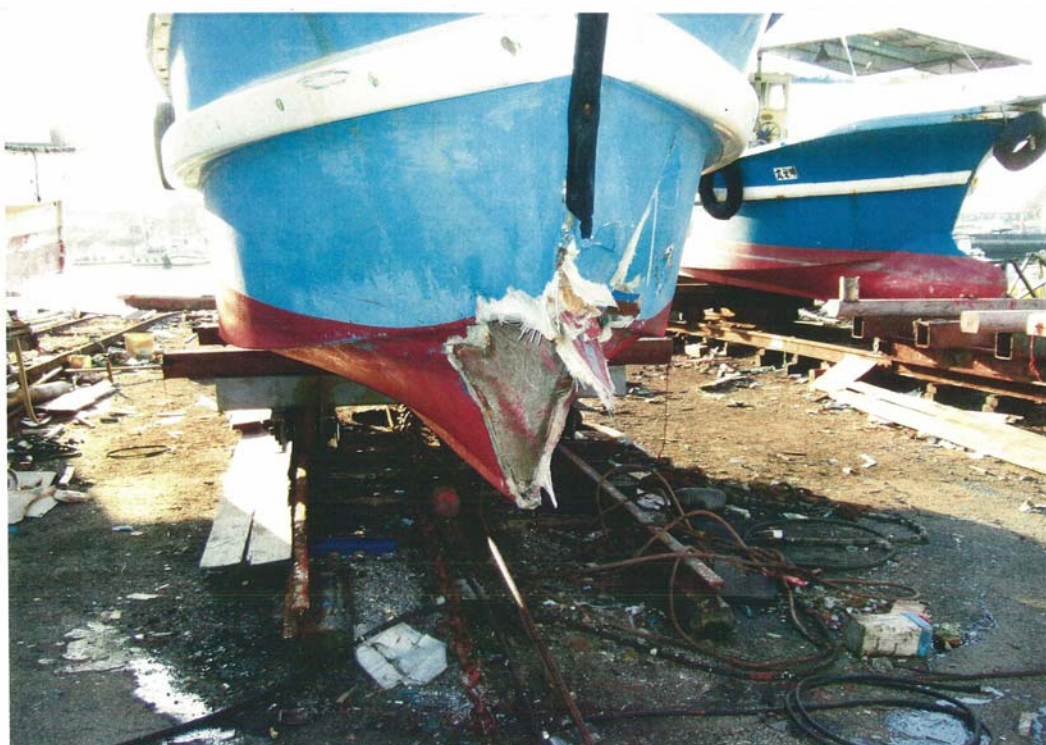
写真2 A船船首損傷状況
