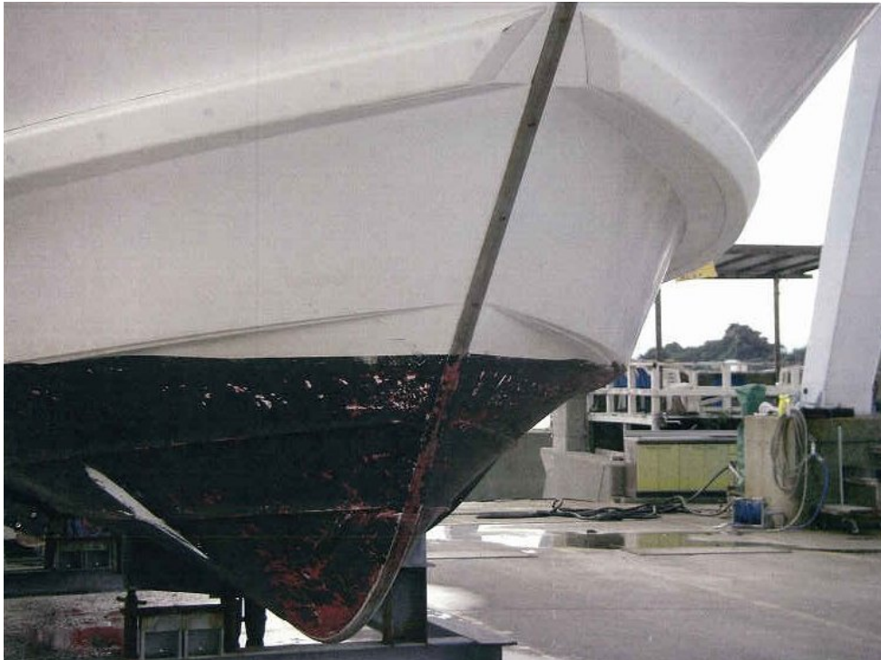
写真2 A船船首の損傷状況
