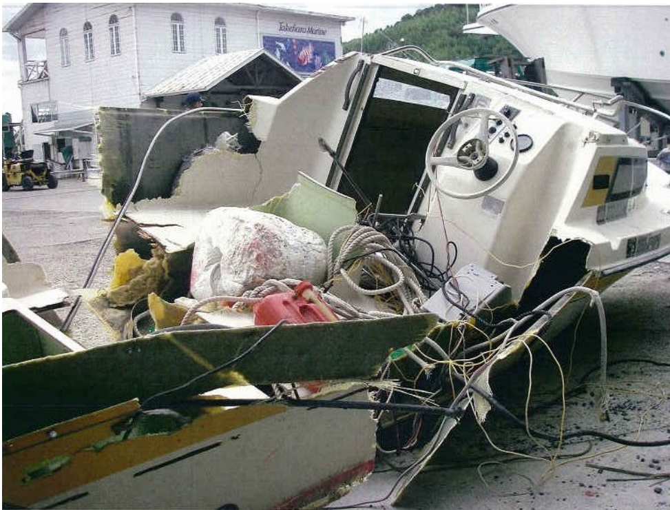
写真4 B船中央部損傷状況
