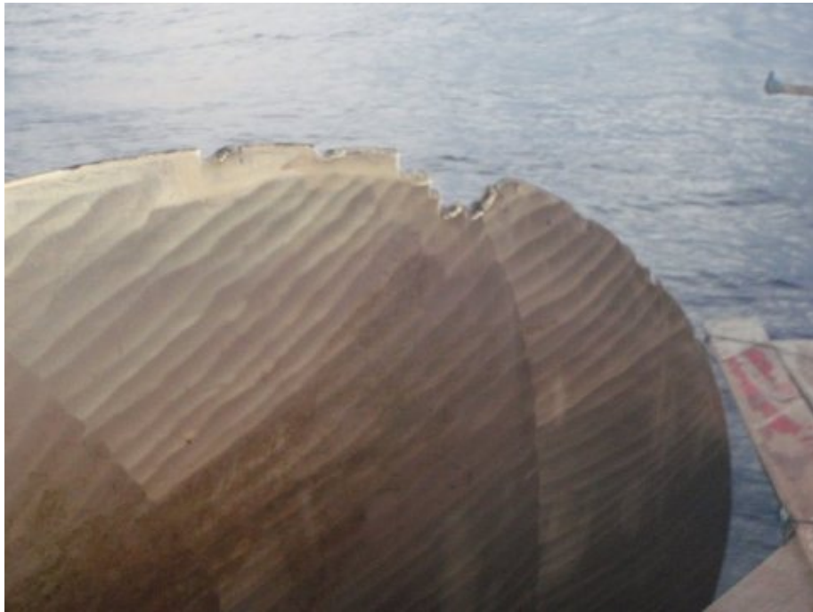
写真5 推進器翼損傷の状況
