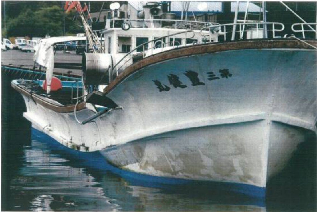
写真1 A船の損傷状況（船首部擦過傷）
