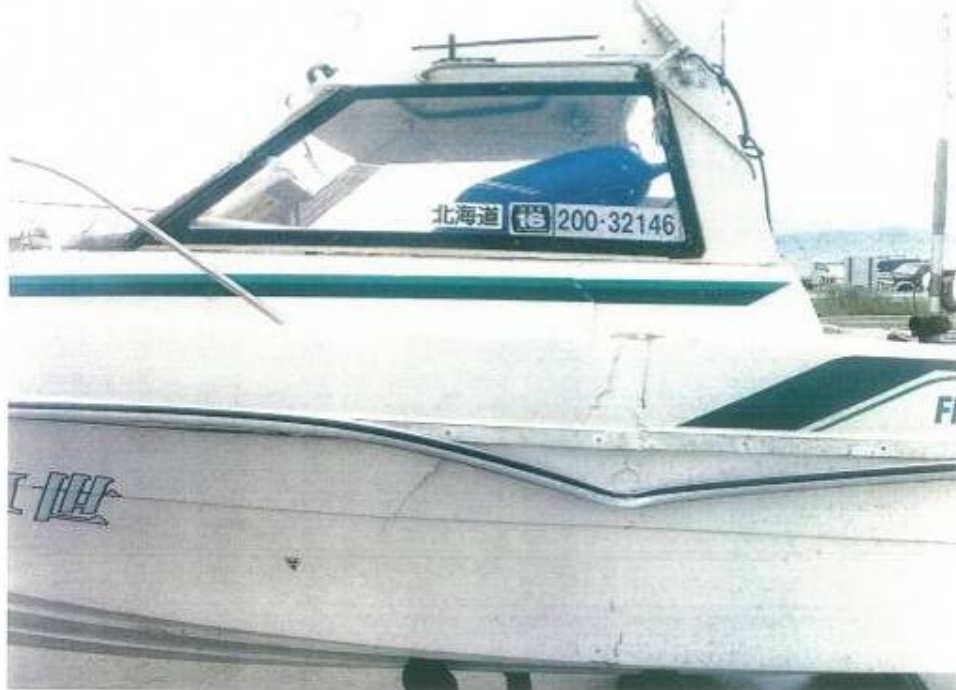
写真3 B船の損傷状況（左舷中央部）
