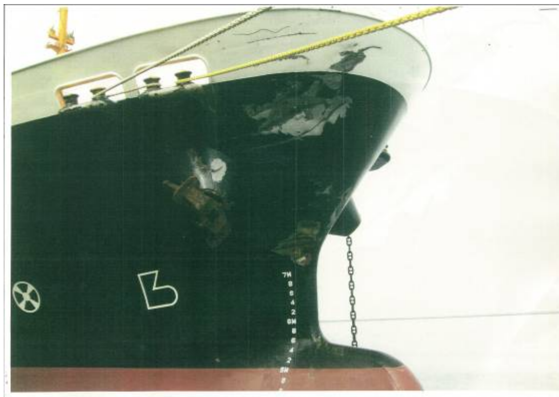
写真1 A船の船首外板損傷状況
