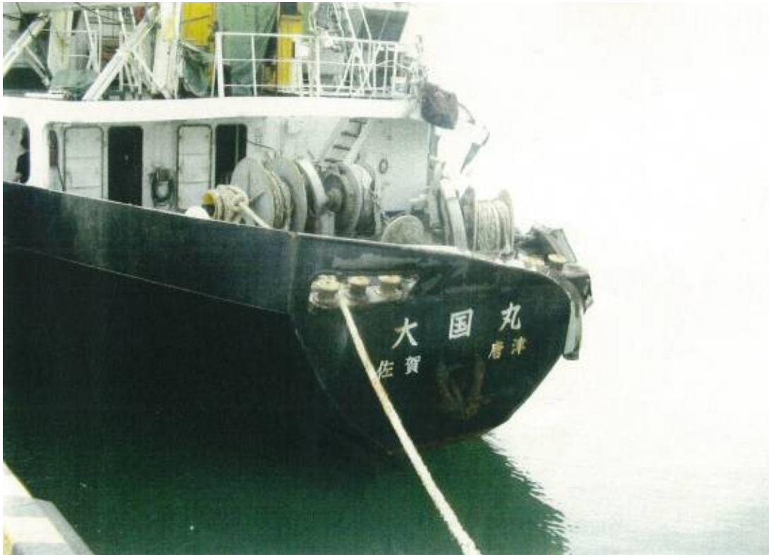
写真3 B船の船尾損傷状況
