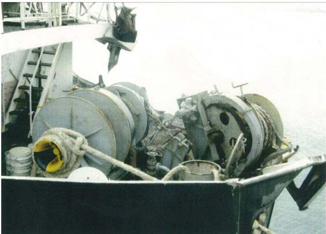
写真4 B船の係船機等損傷状況
