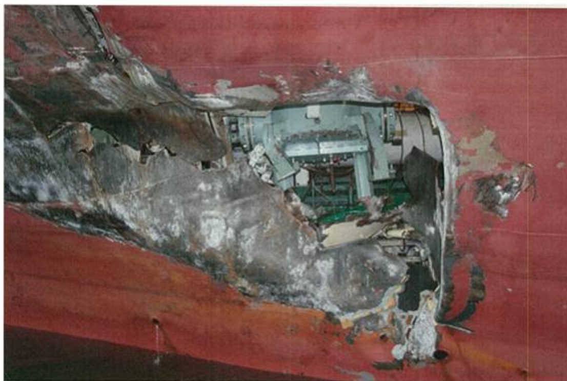
写真2 船体の損傷状況（右舷船尾部）
