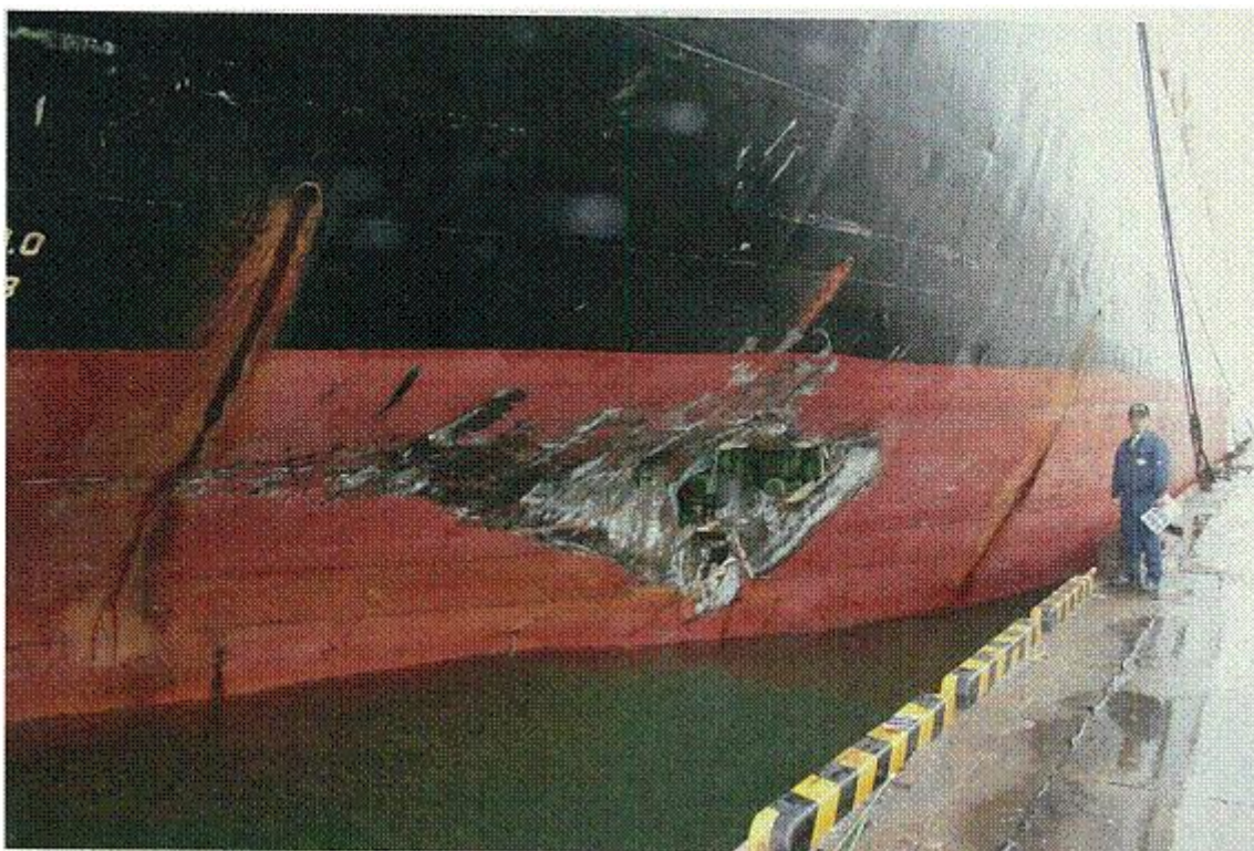
写真1 船体の損傷状況（右舷船尾部）
