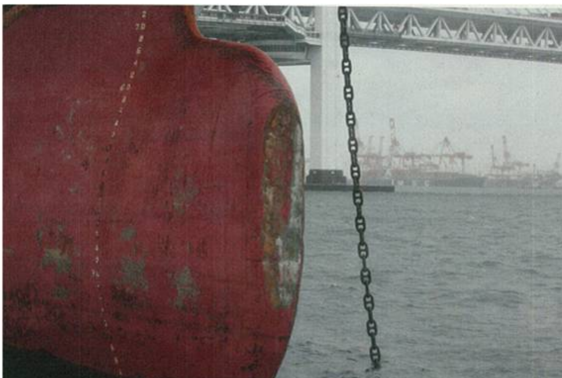
写真4 船体の損傷状況（球状船首部）
