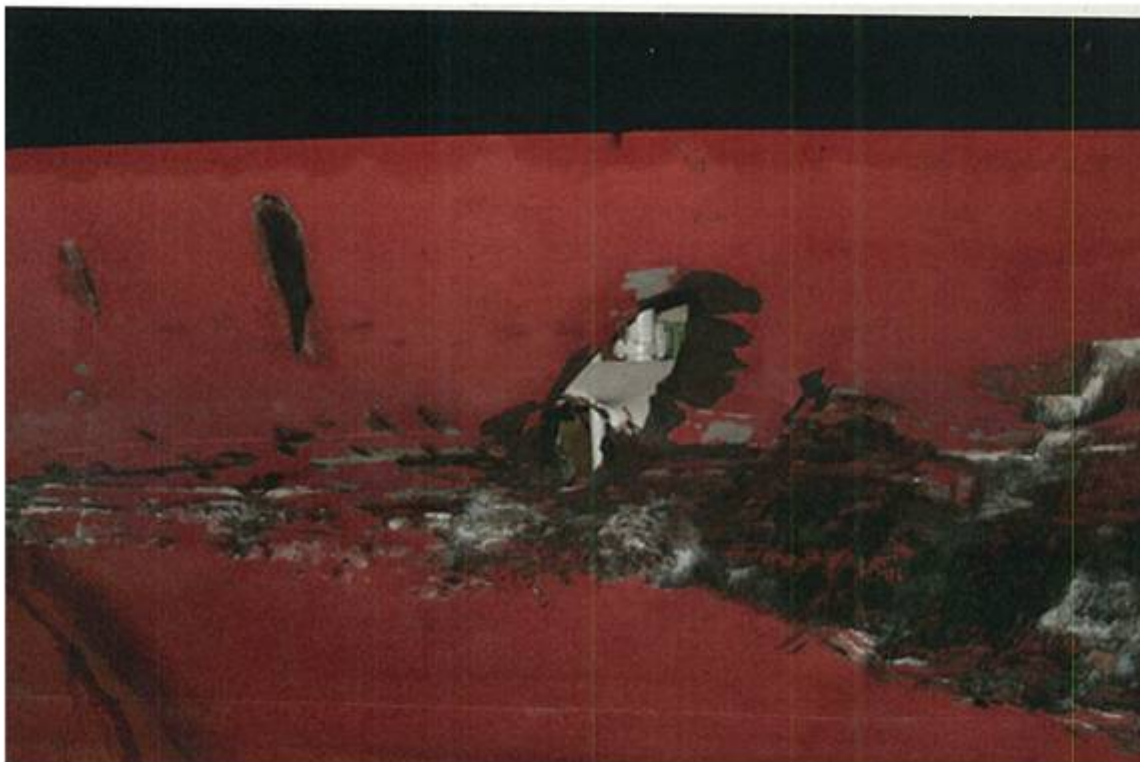
写真3 船体の損傷状況（右舷船尾部）
