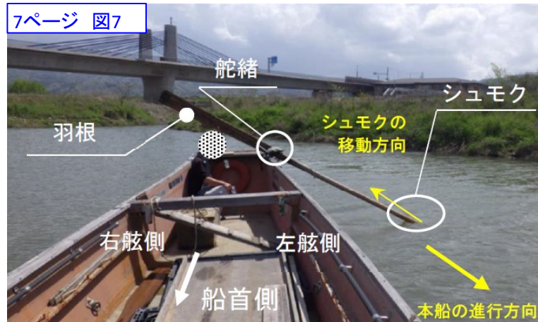
船頭Cが舵をつかもうとしたときの 舵の状況(イメージ)
