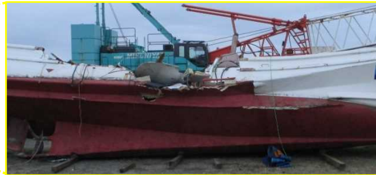
操舵室が損壊し、右舷中央部の破口等
