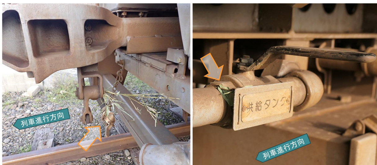
図8 車両床下機器への植物の付着状況
