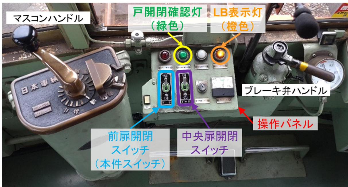
付図4 本件車両の運転台機器類
