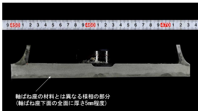
図6 本件軸ばね座の断面の状況
