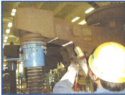
台車枠検査箇所 ① の剥離作業
