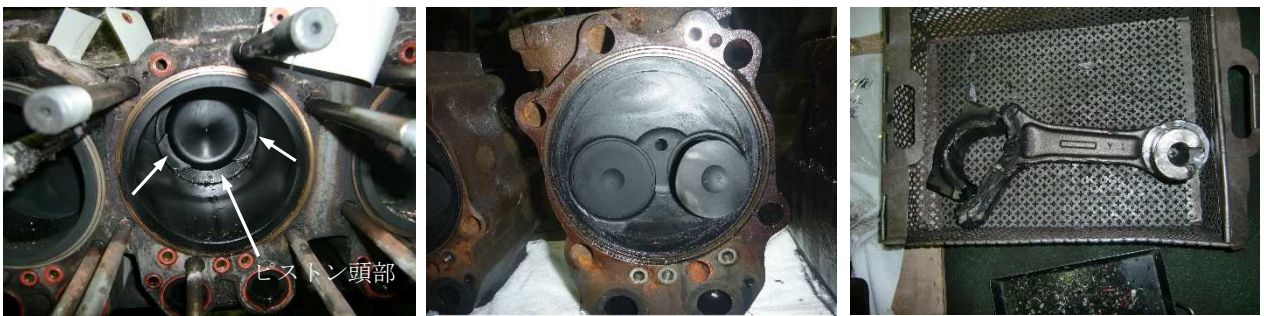
ピストン頭部の弁スタンプ痕
