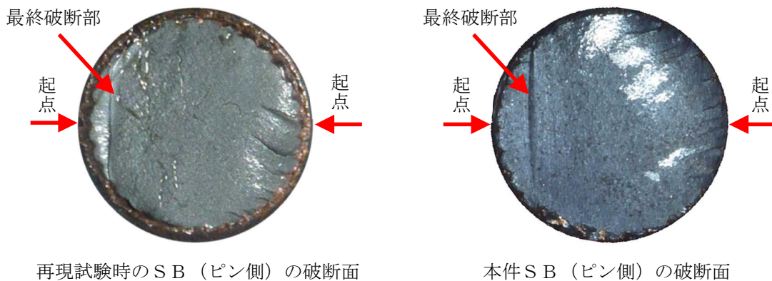
図11 破断面の状態
