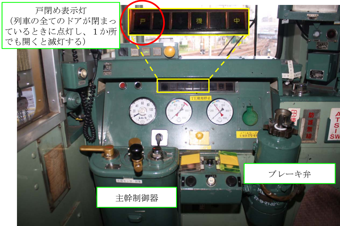
付図3 本件列車の運転台と戸閉め表示灯の状況
