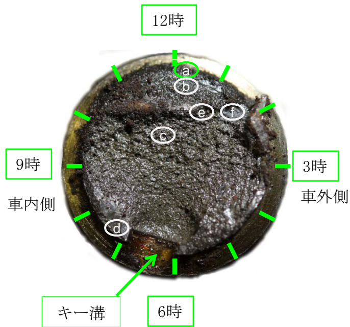
(3) ピストン棒側の破断面
