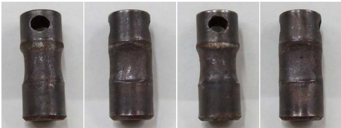
B. 本件ドア戸袋内から発見された本件連結ピン (全周を撮影)
