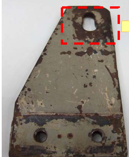
A. 連結板(ドア側の金具) (インシデント発生時点の金具)
