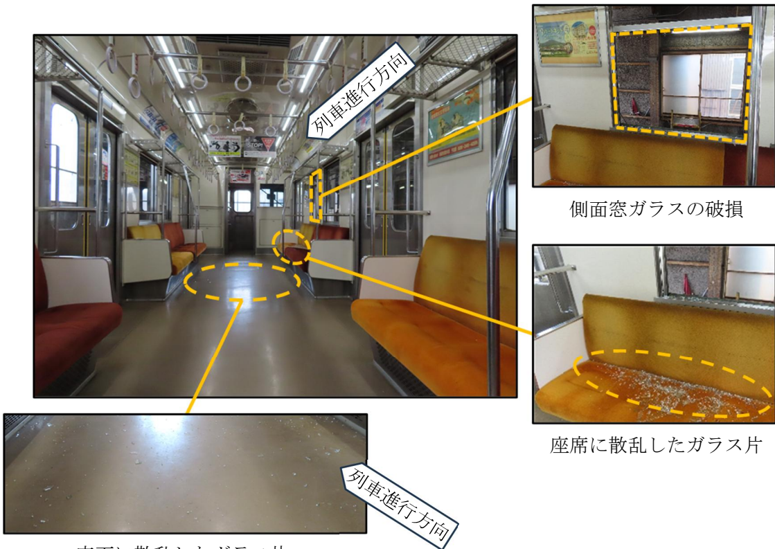
床面に散乱したガラス片
