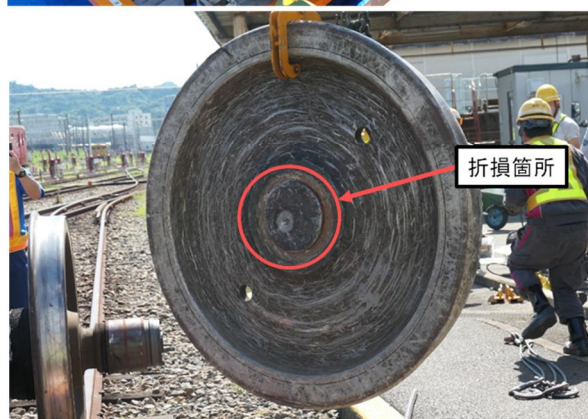
図3 車軸の折損状況
