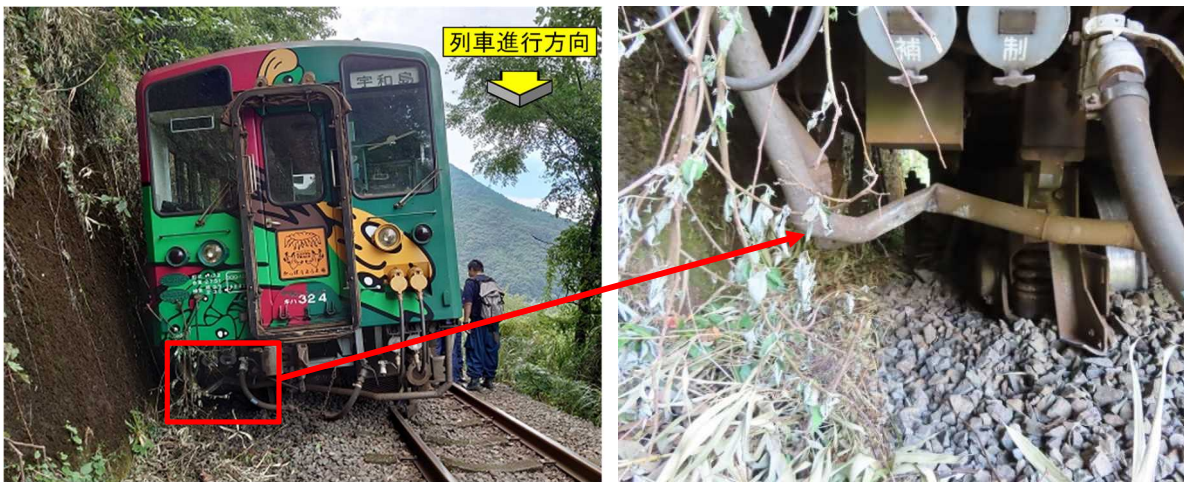
図4 アニマルガードの損傷状況
