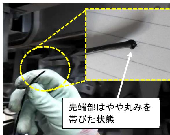
本断線状況 (先頭側電線)
