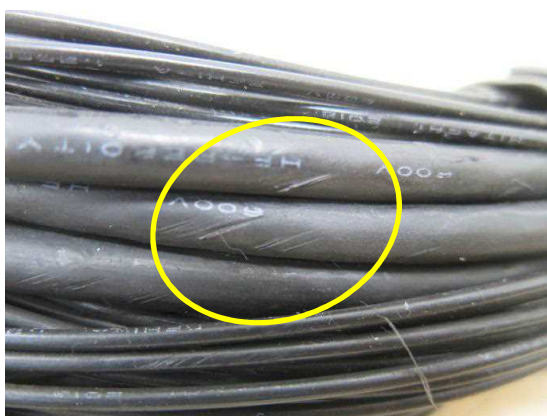
図10 他のケーブルの傷
