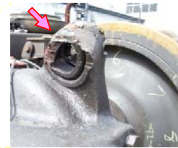
減速機吊り部の損傷
