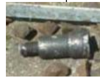
脱落した減速機吊りピン (68k875m付近)
