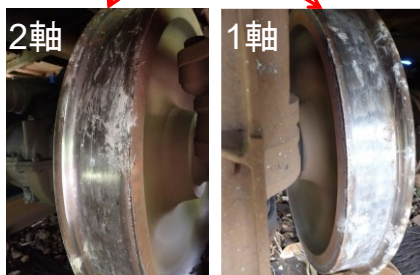
車輪の踏面、フランジ、表リム面の擦過痕
