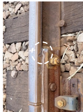
⑨まくらぎNo. 0付近右継目板 の角の衝撃痕
