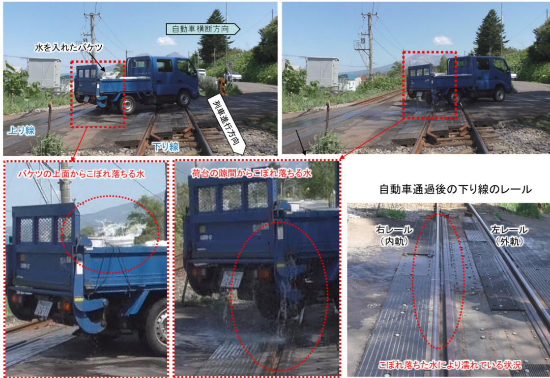
図12 道路交通による液体の落下試験
