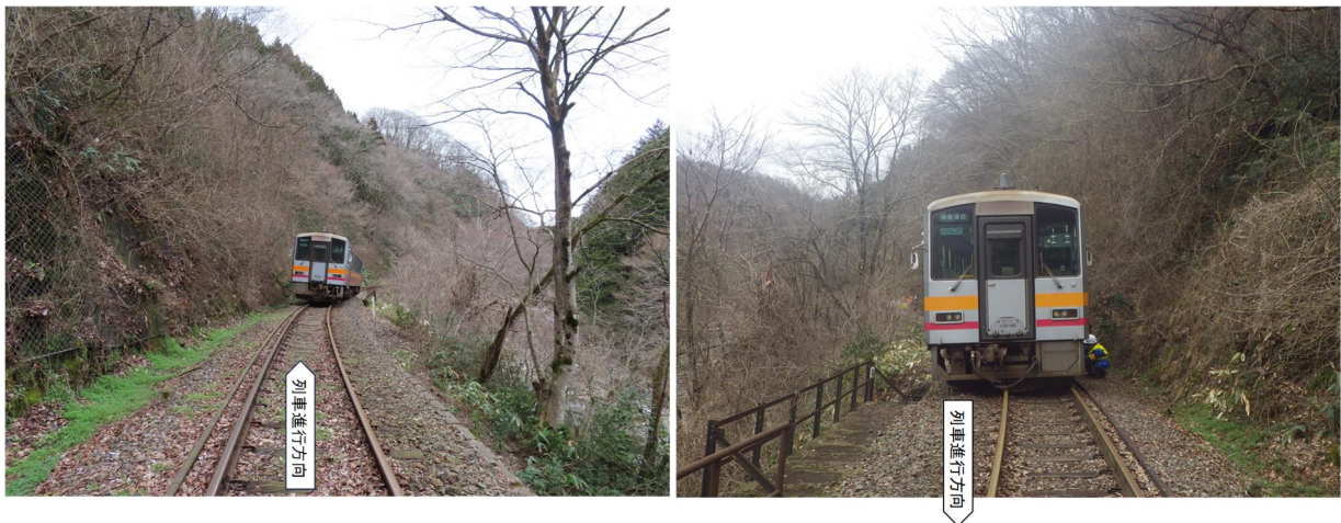
付図4 脱線の状況
