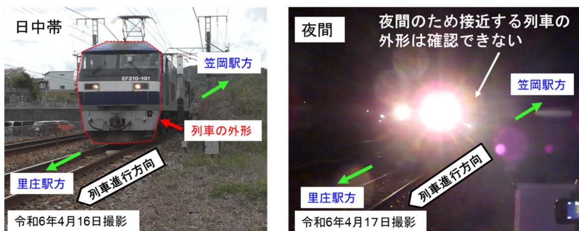
図27 日中帯・夜間における列車見通しの状況
