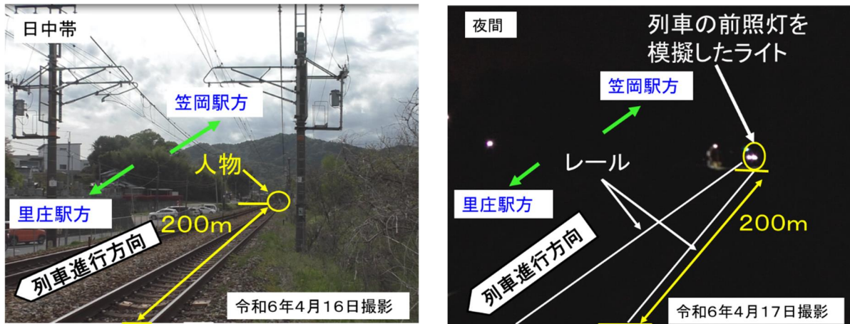
図 2 2 確認位置 A からの列車の見通し状況
