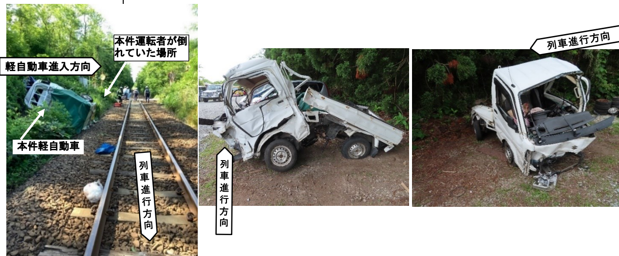
図1-1 本件軽自動車の損傷状況
