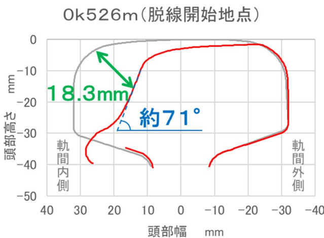
図2 事故現場付近のレール断面図
