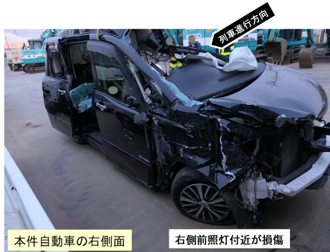
図12 本件自動車の主な損傷状況
