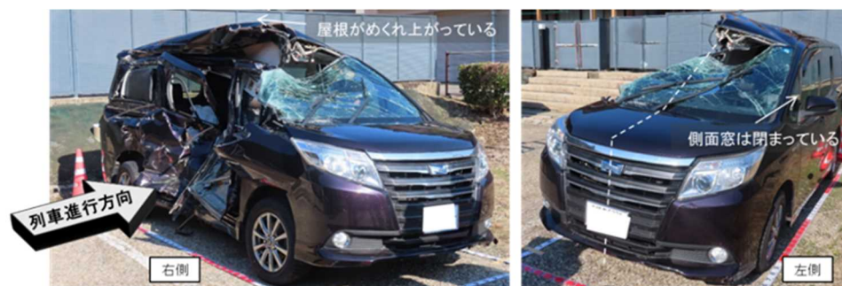
図11 本件自動車の損傷状況
