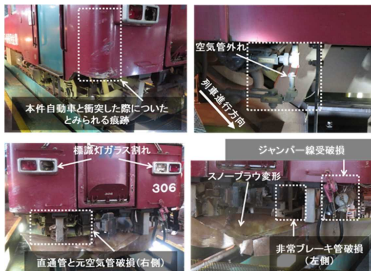
図10 本件列車の損傷状況
