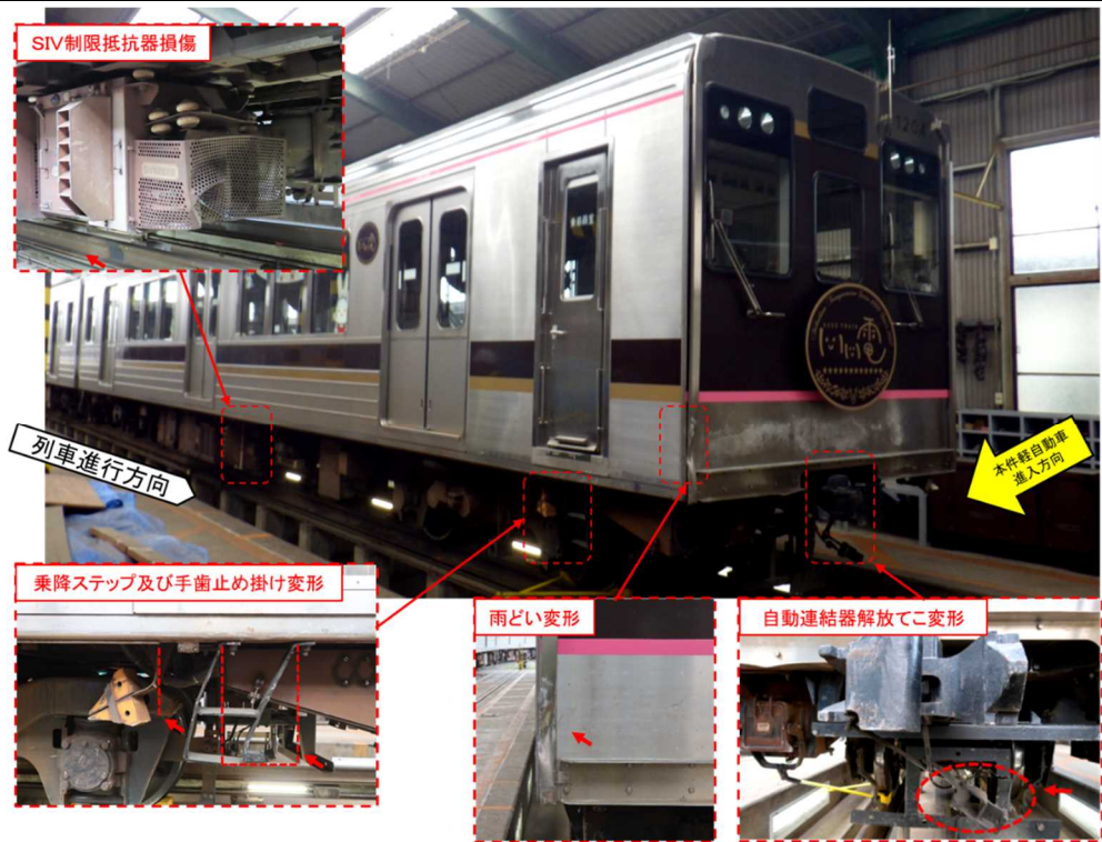
図8 鉄道車両の主な損傷状況
