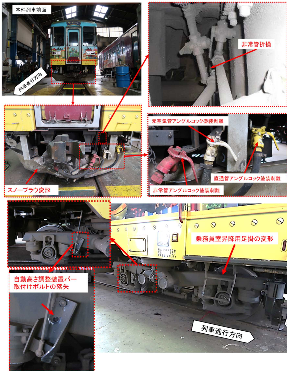
図7 鉄道車両の主な損傷状況
