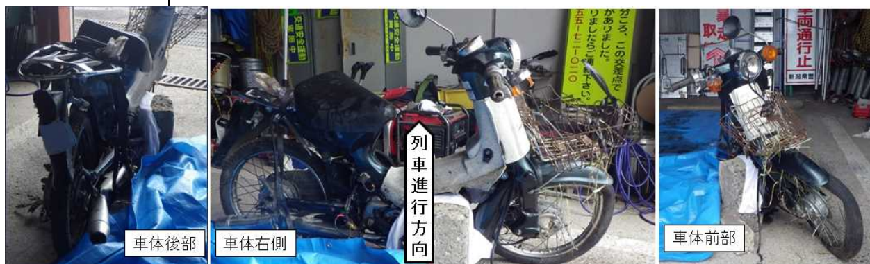
図10 本件原付の損傷状態
