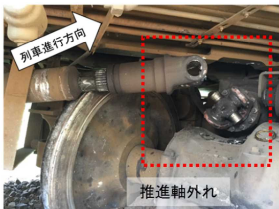
G: 本件車両前台車第2軸付近
