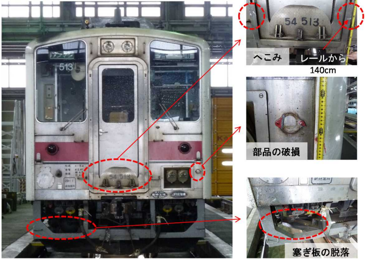
写真4 本件列車の損傷状況
