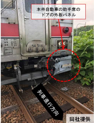
写真6 事故発生直後の本件列車前面下部の状況
