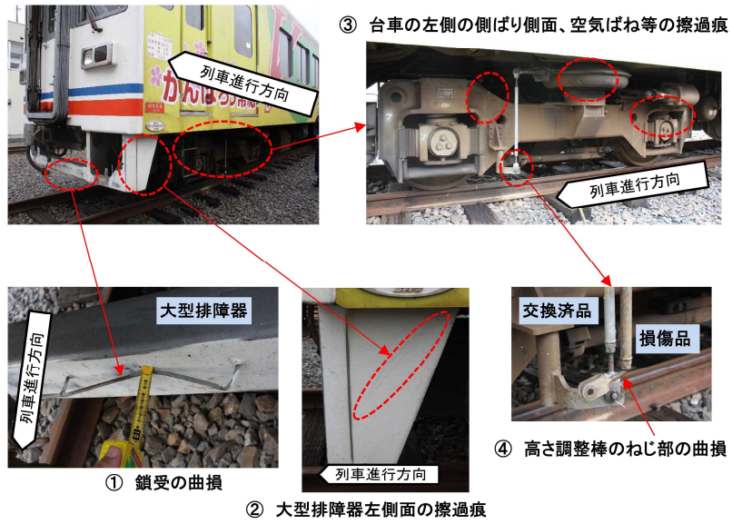
写真7 車両の損傷状況（事故後、車両基地内で撮影）
