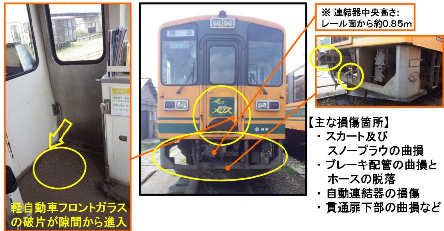
写真3 車両の損傷状況
