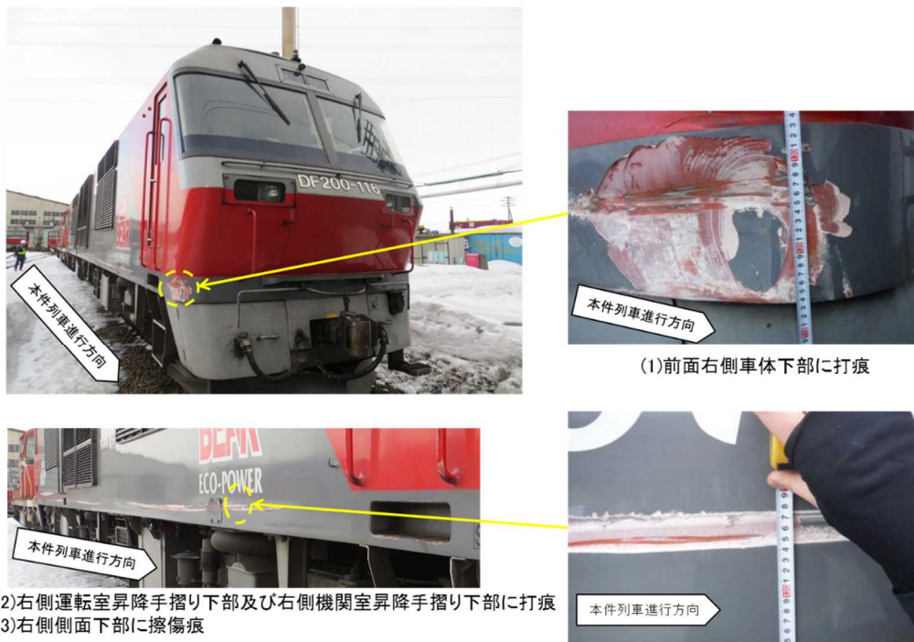
写真5 本件機関車の主な損傷状況
