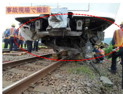
鉄道車両の損傷箇所（前面下部）
