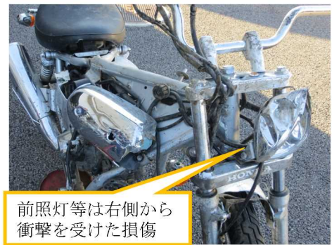
写真4 原付の損傷状況
