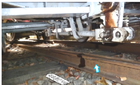
↓ リードレール頭部左側面の擦過痕
