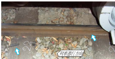
↓ リードレール頭部左側面の擦過痕
