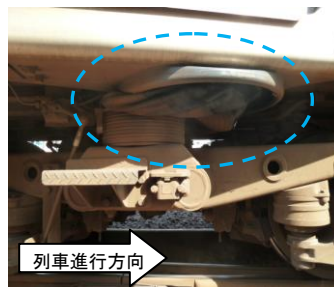
本件車両後台車右側 空気ばねエア抜け
