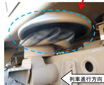
本件車両後台車左側 空気ばねエア抜け
