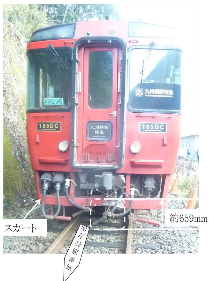
写真6 主な損傷状態（1両目車両のスカート）
